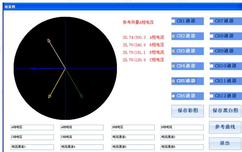
图 7.24 相量图工具
