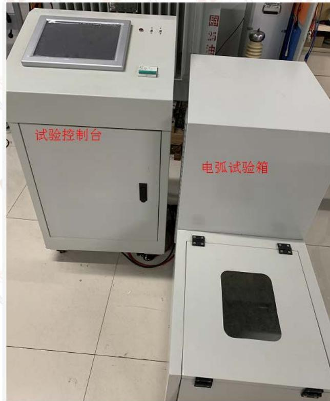
图 2 低压手套电弧试验装置组成
