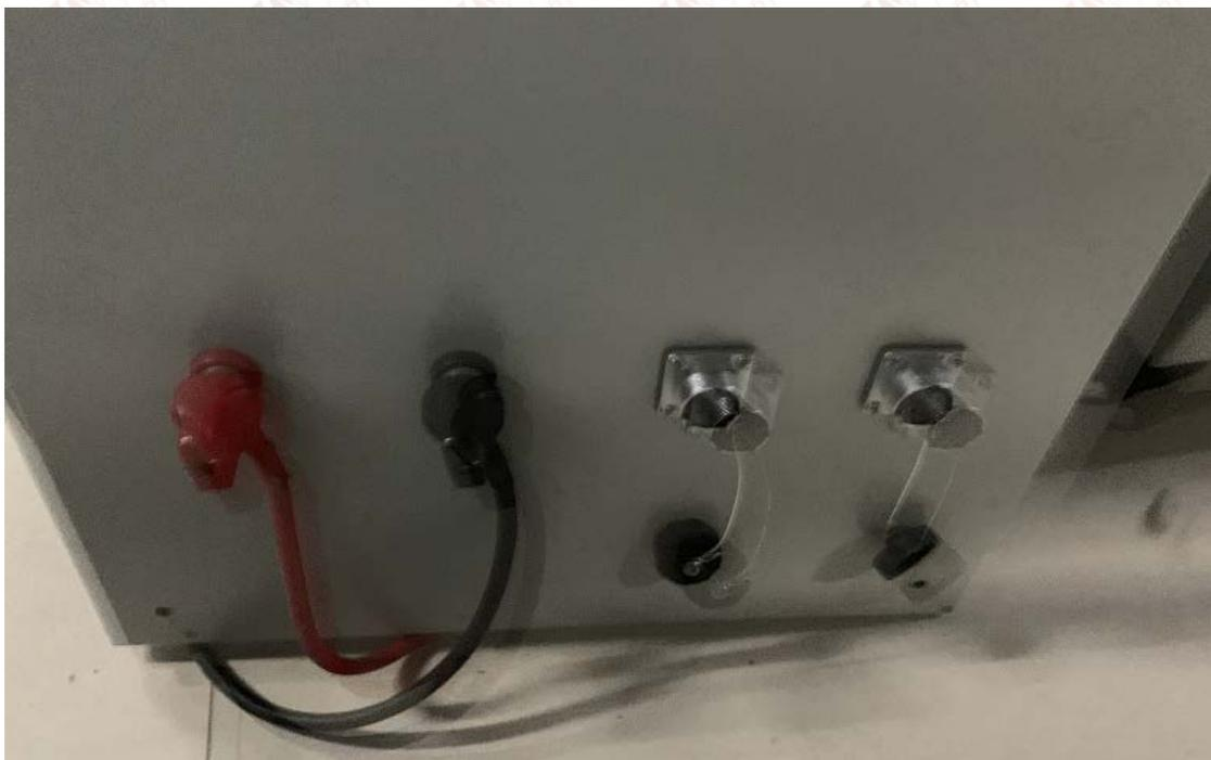
图 6.1 试验控制台和电弧试验箱连接
