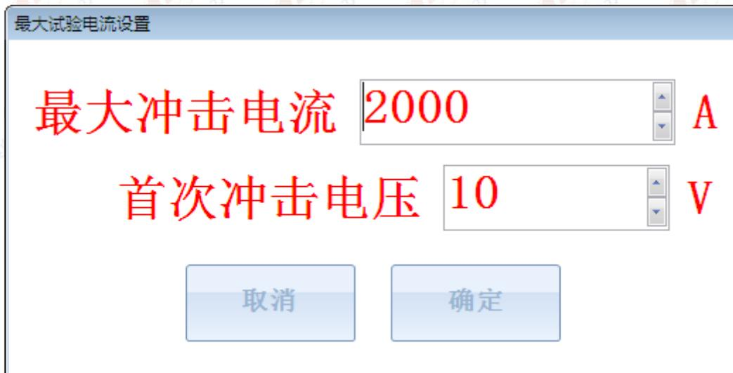
图 7.6 试验参数设置界面
